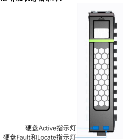
图 2-5 8 个 3.5" 硬盘背板&12 个 3.5" SAS/SATA 直通背板&12 个 3.5" SAS/SATA 扩展背板 &24 个 2.5" 硬盘背板状态指示灯
