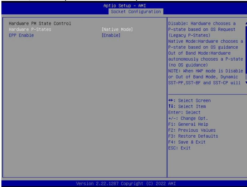
图 3.5-19 Hardware PM State Control 界面
