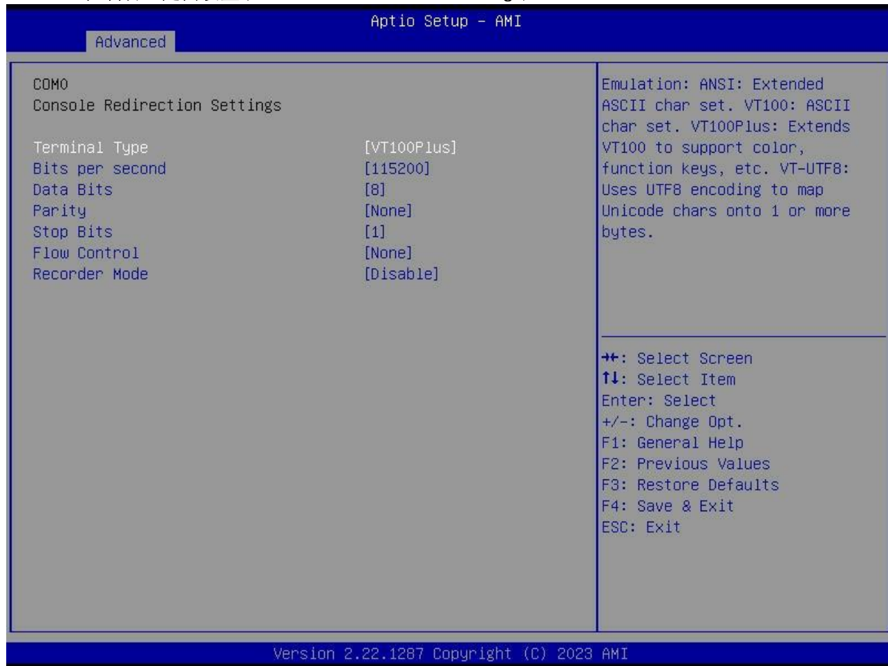
图 3-3-5 Console Redirection Settings (COM0) 界面
