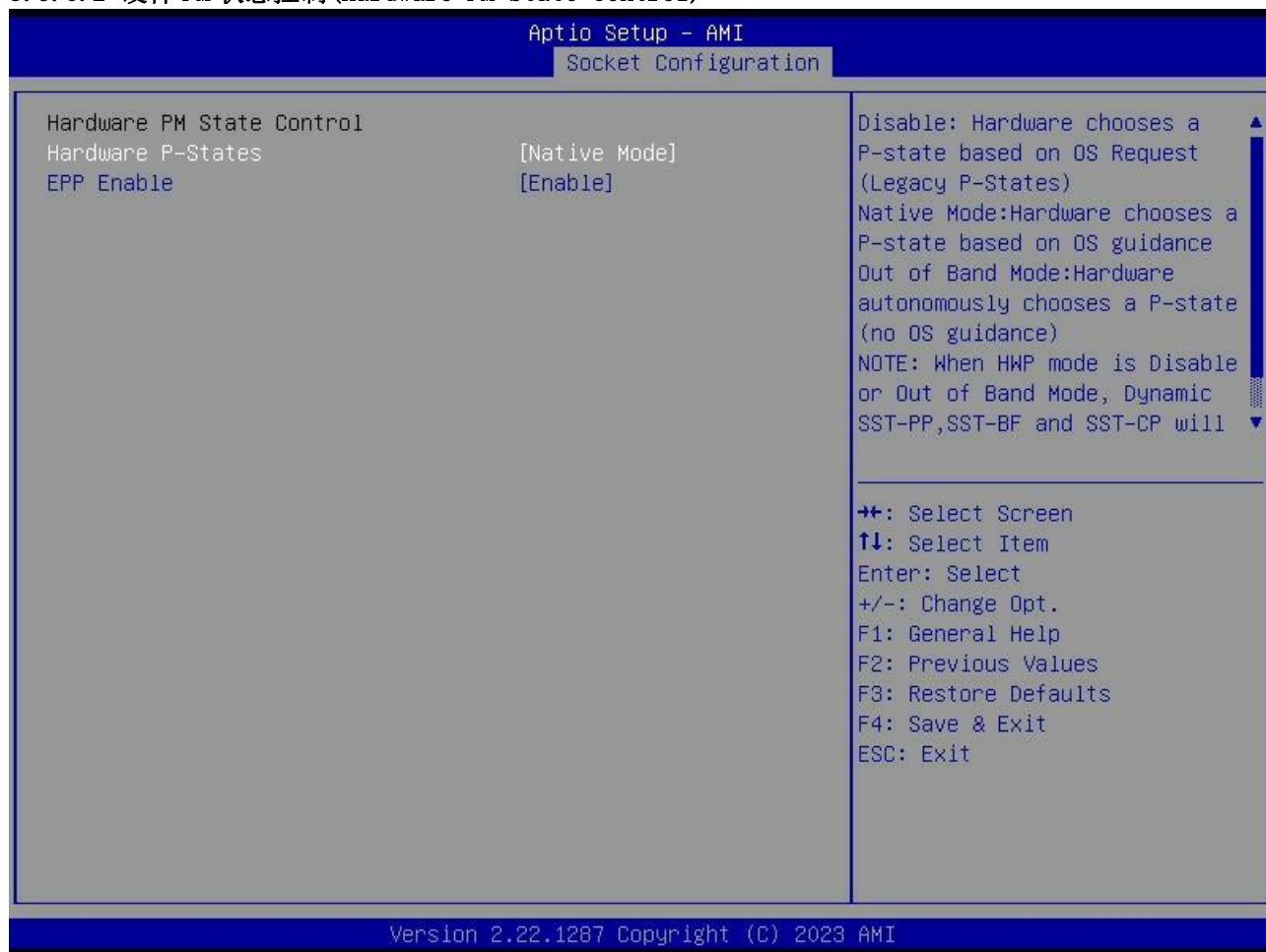
图 3-5-19 Hardware PM State Control 界面
